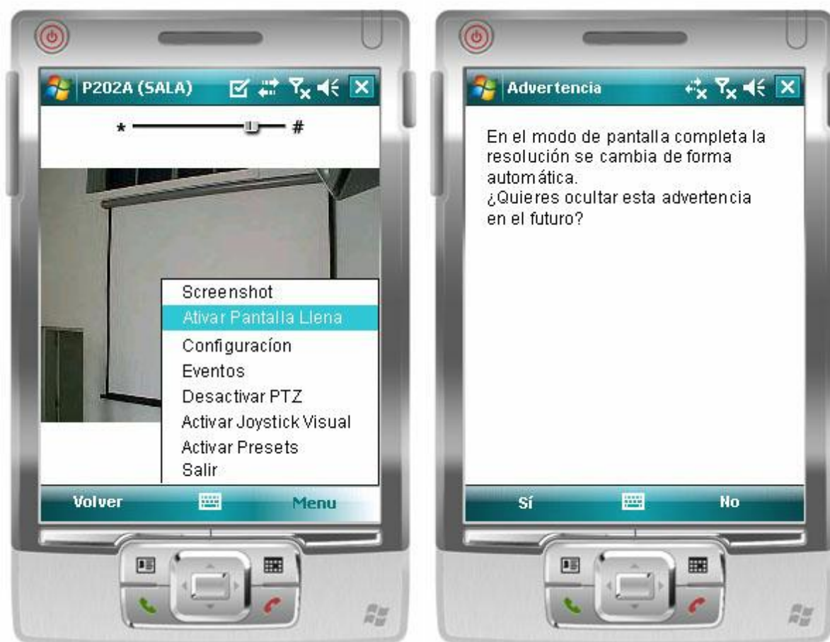
(Fig. 37 y 38) Menú "Activar Pantalla Llena" con el alerta de alteración de resolución
